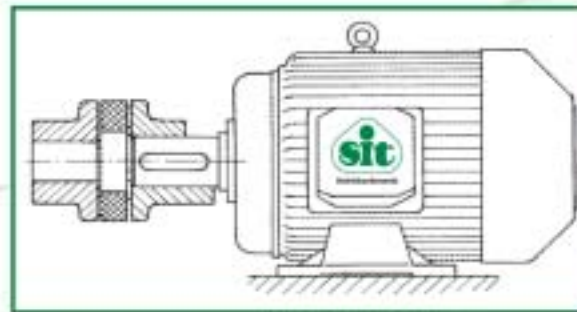
TRASCO-Kupplungen für IEC-Normmotoren (Zahnkranz 92 Shore A (Standard))
