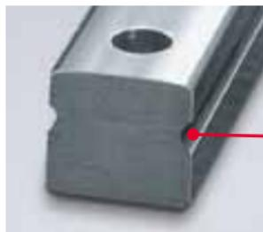
Innerhalb der Kugellaufbahn keine Nut für einen Rückhaltdraht. So ist eine bessere Schmutzabdichtung gegeben.
