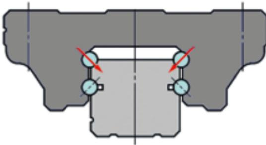
Bei normaler Last wirkt die Kugel der unteren Laufbahn an der Schiene nach oben. Es ist ein Spalt mit wenigen  $\mu\text{m}$  zur unteren Flanke der unteren Kugellaufbahn vorhanden.
