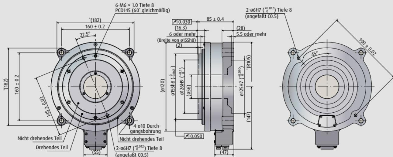
Für Abmessungen mit \* ist eine Extratoleranz von 3mm im Montagebereich auf Grund von Abweichungen notwendig. Wenn ein Paßfederstift in der Paßstiftbohrung montiert ist:
