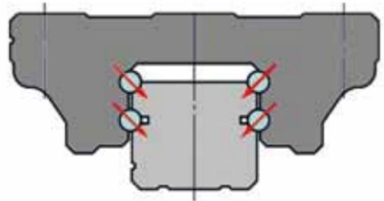
Bei Belastung federt die obere Kugel ein. Bei höheren Belastungen ist die Einfederung so stark, dass die untere Flanke der unteren Kugellaufbahn beginnt Last aufzunehmen. Dies ist gerade im Überlastfall eine zusätzliche Absicherung, die durch kein anderes Schienenprofil gegeben ist.
