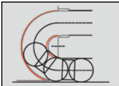
Die Endkappen wurden konstruktiv angepasst, um die Umlenkung der S1™-Spacer zu verbessern.
