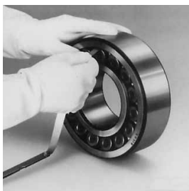
Abb. 1: Überprüfen der Lagerluft im ausgebauten Zustand
