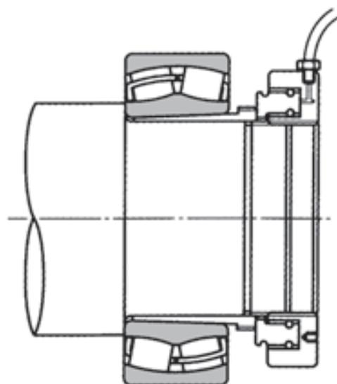
Montage mit Hydraulikmutter
