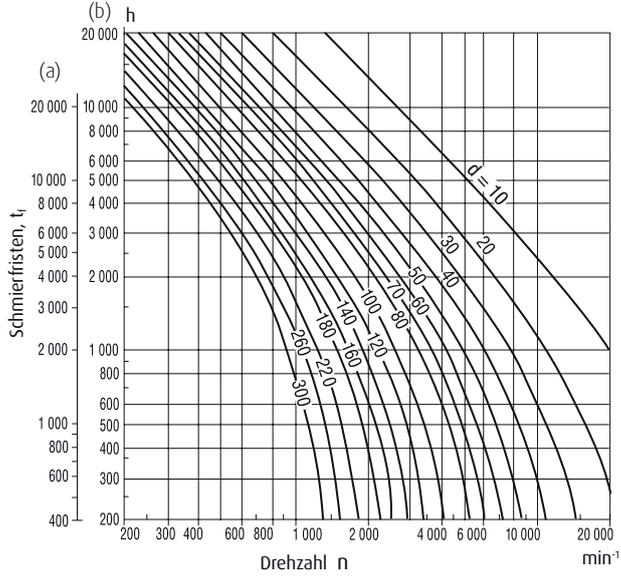
(2) Kegelloberlager, Pendelrollenlager
