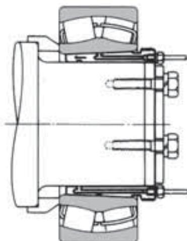
Montage mit spezieller Abziehhülse und Hydrauliköl
