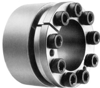
Besteht aus einem Innen- und einem Außenring. Hochpräzise Verbindung für besonders hohe Drehmomente. Beim Einbau tritt an der Nabe eine minimale Axialverschiebung auf.
