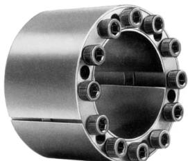
Geeignet für sehr hohe Drehmomente. Durch die großen Spannflächen ergeben sich nur geringe Flächenpressungen auf Welle und Nabe. Kann Biegemomente aufnehmen, keine Axialverschiebung
