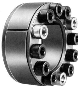
Vierteiliges Spannelement mit 2 doppelt konischen Innenringen. Nicht selbstzentrierend und daher leicht zu demontieren. Geeignet für mittlere Drehmomente. Die Passung der benötigten Vorzentrierung, bestimmt die Rundlaufgenauigkeit.
