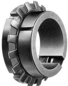
Besteht aus zwei konischen Ringen, einer Ringmutter und einer Sicherheitsscheibe. Es wird ein vorzentrierter Passsitz zwischen Welle und Nabe benötigt. Geeignet für kleine und mittlere Drehmomente.
