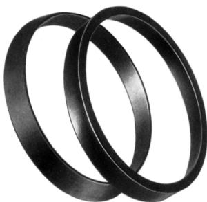
Besteht aus zwei konischen Ringen und ist mit einem Befestigungsflansch zu versehen. Die Anzahl der Schrauben ist vom zu übertragenden Drehmoment abhängig. Geeignet für niedrige Drehmomente und enge Einbauverhältnisse. Es können bis zu vier Einheiten montiert werden, wodurch die Übertragung relativ hoher Drehmomente ermöglicht wird.
