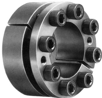
Besteht aus einem Innen- und Außenring. Kurze Einbaulänge und dadurch besonders geeignet für schmale, scheibenförmige Radnaben. Überträgt relativ hohe Momente. Beim Einbau tritt eine geringfügige Axialverschiebung auf.
