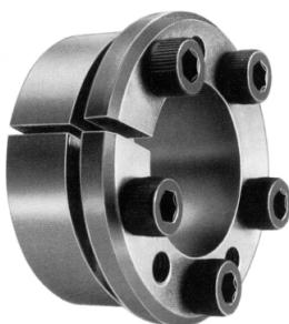
Besteht aus zwei konischen Ringen. Der Flansch am Innenring dient als Anschlag für die exakte Positionierung der Nabe in Achsrichtung. Sehr geringer Axialplatzbedarf. Geeignet für relativ hohe Momente. Bei gleichem Außendurchmesser ist diese Ausführung für verschiedene Wellendurchmesser erhältlich.
