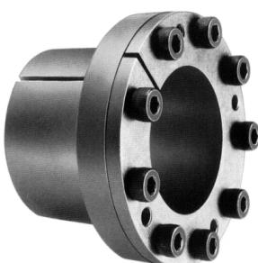
Besteht aus zwei konischen Teilen und einem Distanzring. Geeignet für relativ hohe Drehmomente. Der extrem kleine Außen-durchmesser benötigt nur einen minimalen Platzbedarf. Der Distanzring verhindert jede Axialverschiebung auch ohne Wellenbund. Anwendbar bei Wellen mit 6 bis 130 mm Durchmesser.
