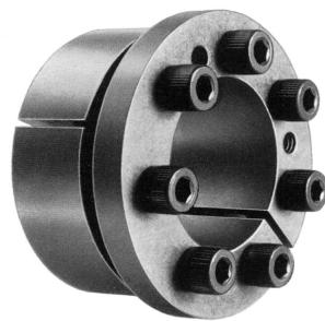
Besteht aus zwei konischen Ringen. Der Flansch am Innenring dient als Anschlag für die exakte Positionierung der Nabe in Achsrichtung. Kurze Einbaulänge. Überträgt relativ hohe Momente
